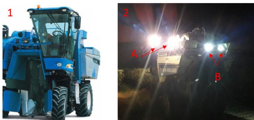
Figura 12. – Imagem de máquinas de colheita retirado de catálogo da empresa New Holland (1). Conjunto de faróis que equipam as máquinas observadas no terreno (2). A - Faróis direcionados para as oliveiras, colocados no plano do topo das árvores. B - Faróis superiores que iluminam a área envolvente à área de progressão da máquina.
