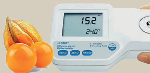
Figura 11 – Métodos químicos: Refractómetro para medição do ° Brix. Nível de açúcar (igual ou superior a 14 °Brix)
